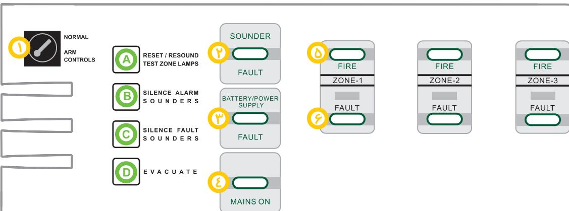
سوئیچ در حالت Arm Control باعث فعال شدن کلیدهای A و B و C و D می شود.
